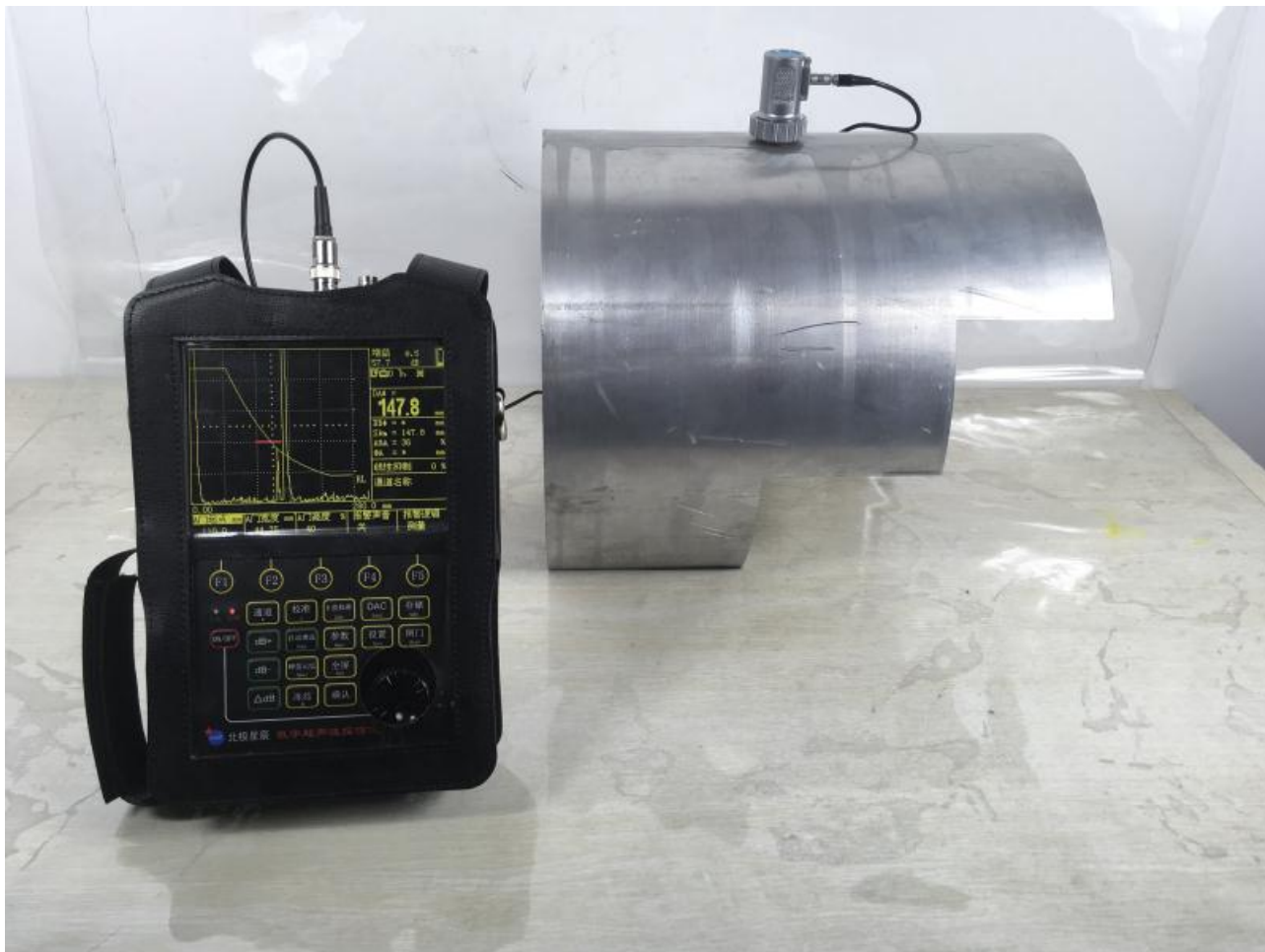
附图 1：用 BSN910 超声波探伤仪在铝试块上校准探头的照片
